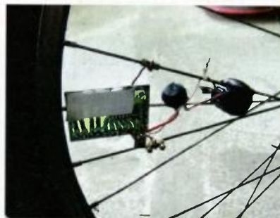
Obr. 5. Uchycení desky na paprscích kola
