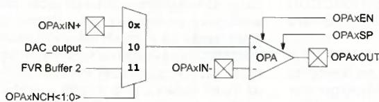
Obr. 10. Blokové schéma modulu operačního zesilovače
