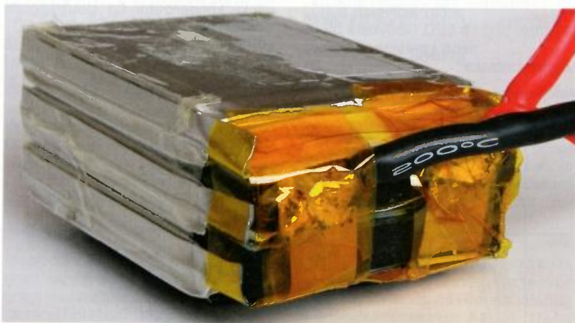
Obr. 2. Použití kaptonové pásky v sadě akumulátorů
