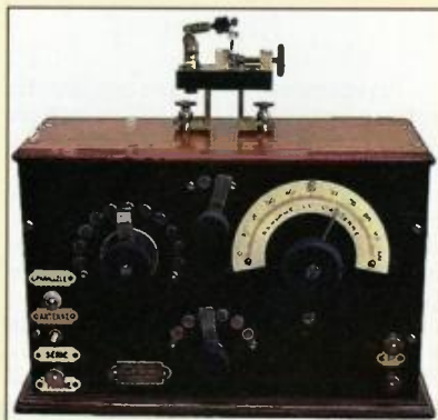
Obr. 15. Krystalka laděná přepínáním kondenzátorů, ale i otočným ladicím kondenzátorem
