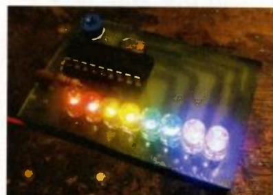
Obr. 4. Osazená deska displeje
