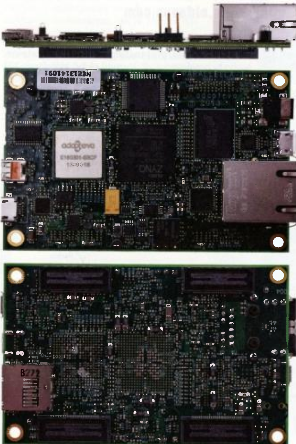
Deska počítače Parallella z boku, shora a zespodu
