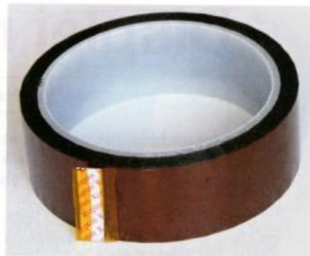
Obr. 1. Cívka s 33 m pásky šíře 30 mm (na zakončení je vidět nápis koptan)
