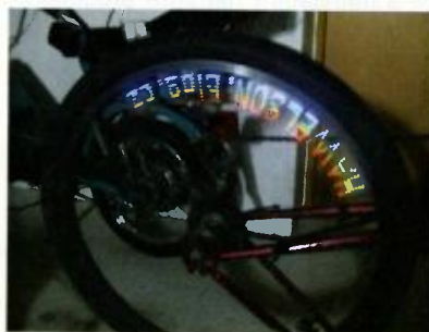
Obr. 6. Displej umístěný na bicyklu. Čím se kolo otáčí rychleji, tím se nápis více natáhne – viz fotografie v úvodu článku
