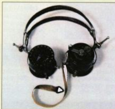
Obr. 17. Krystalka vestavěná přímo do sluchátek
