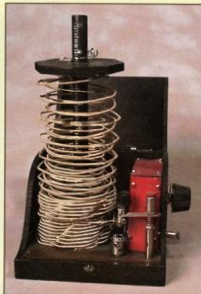
Obr. 11. Ladění krystalky roztahováním drátu cívky
